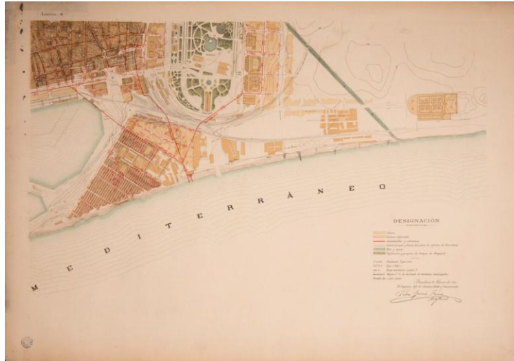
Fig. 11.- Detall de la Làmina 4 del projecte de García Fària on es veu els col·lectors i les clavegueres projectades en aquest sector de la ciutat a 1861. Font: GARCÍA FARIA (1893)
